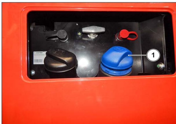
Figure 122: Remplissage du réservoir de DEF
