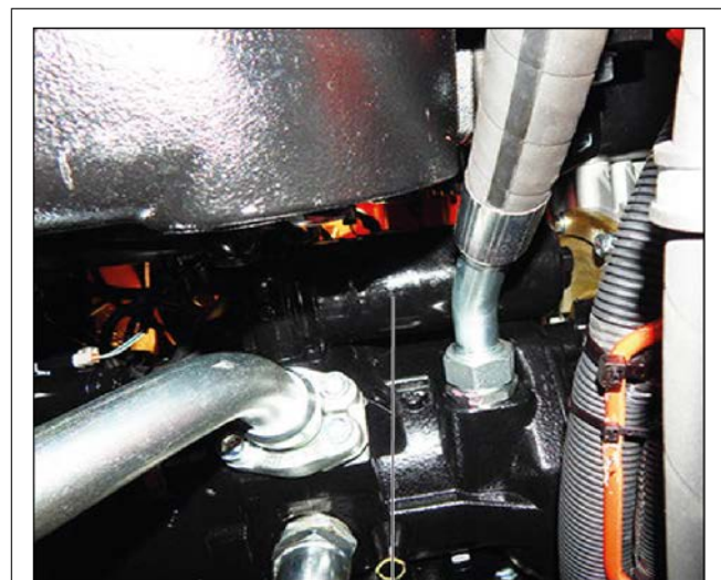
Figure 173: Vérification de la contamination de l'huile hydraulique
